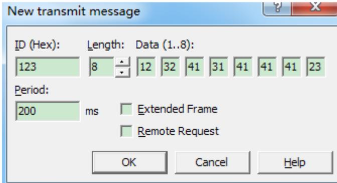
点击 OK 后，如下图，正在发送设置好的 CAN 报文，同理可以新建多条报文。
